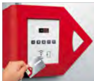
Контроль доступа посредством RFID
